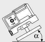
**При монтаже между этими положениями реле давления включается при максимально высоком или низком заданном давлении.**
