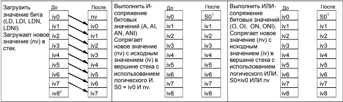
Рис. 6–2. Принцип действия контактов.
