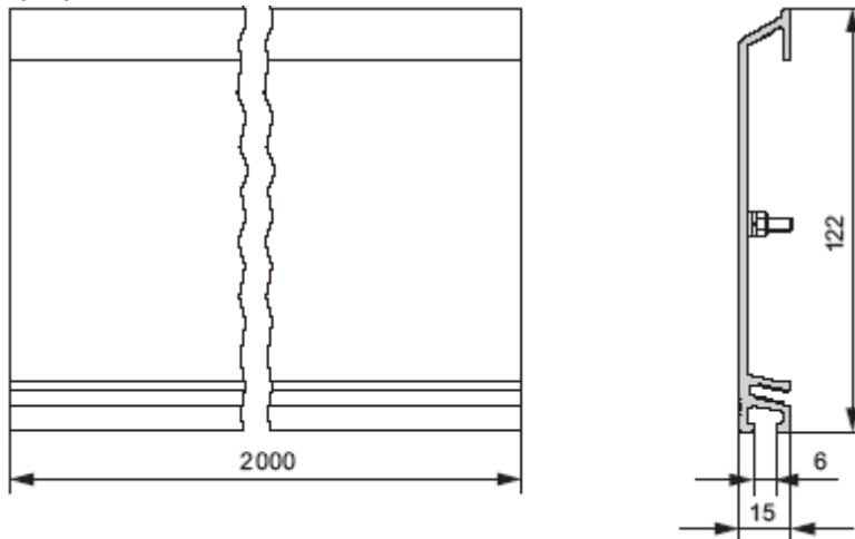
Рис. С-9. Габаритный чертеж 2000-миллиметровой профильной шины
