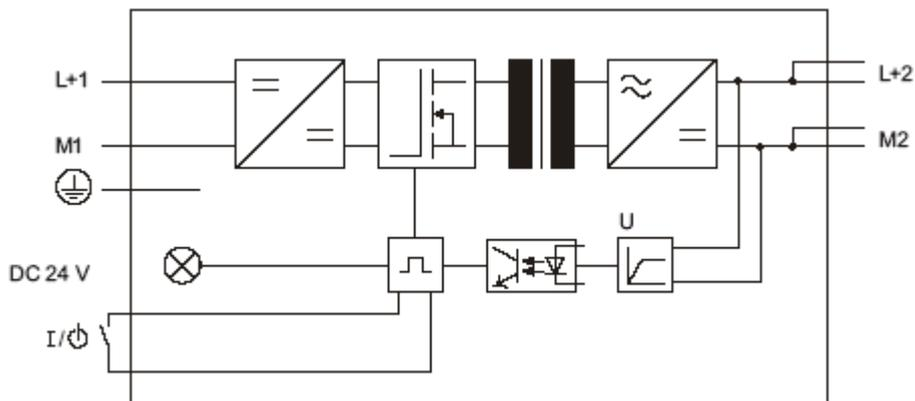
Рис. 2-1. Принципиальная схема блока питания PS 305; 2 А
