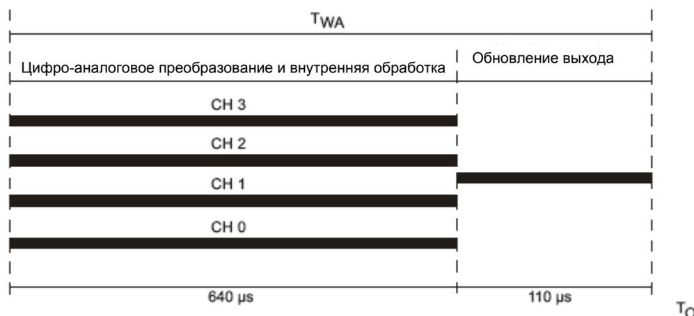
Рис. 6-36. Расчет времени обработки и времени обновления выхода
