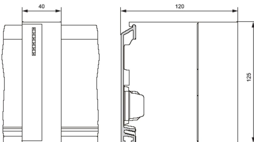
Рис. С-15. Интерфейсный модуль IM 360
