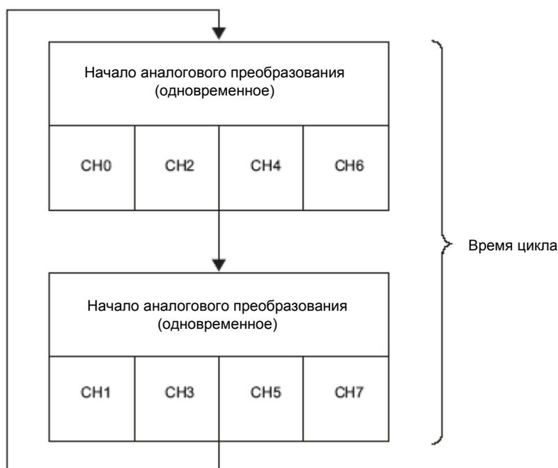
Рис. 6-30. Время цикла для 8-канального режима (программный фильтр)
