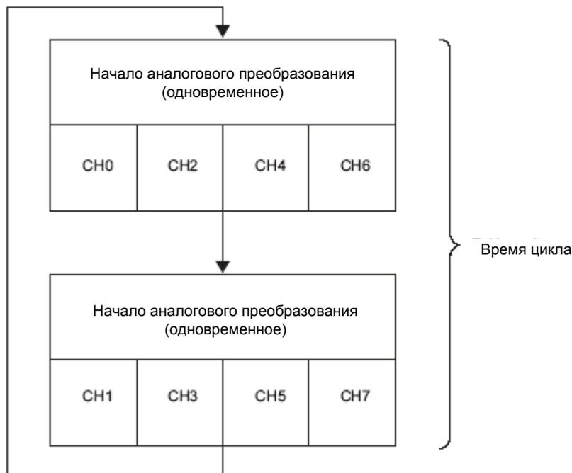
Рис. 6-24. Время цикла для 8-канального режима (программный фильтр)
