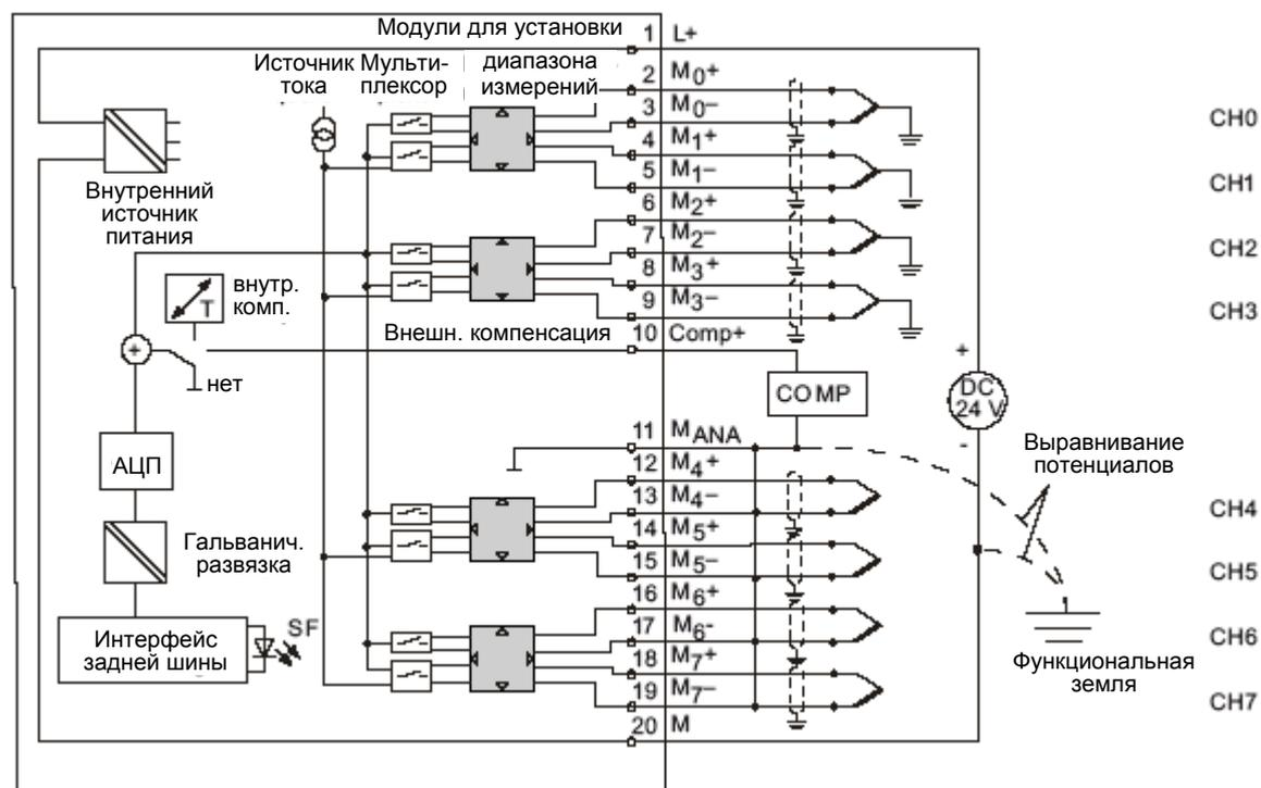
Рис. 6-17. Принципиальная схема и схема подключения
