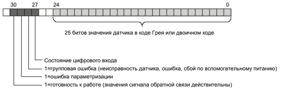
В двойном слове данных канала 0 в бит 27 заносится информация о состоянии цифрового входа I0, а в двойном слове данных канала 1 сообщается о состоянии цифрового входа I1. В двойном слове данных канала 2 этот бит всегда = 0.
