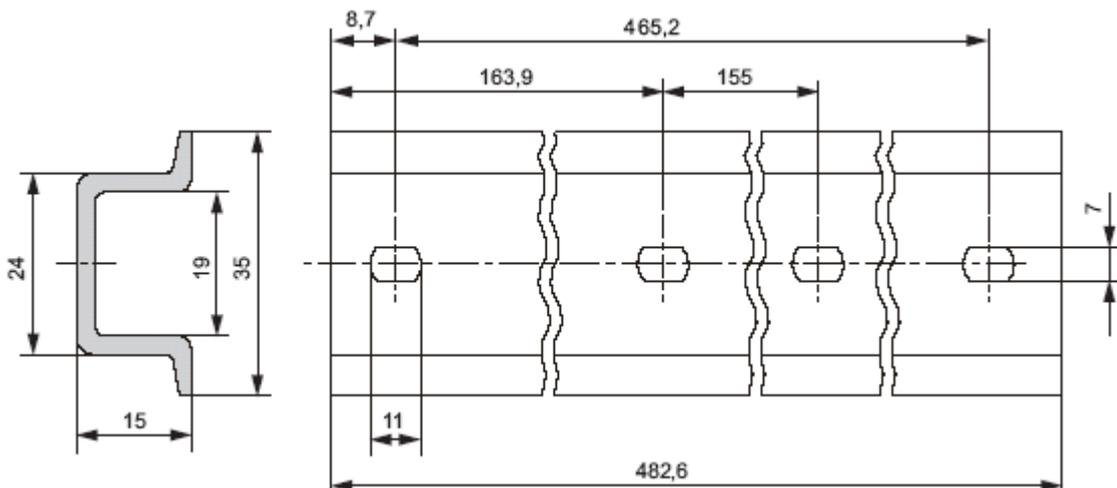
Рис. С-1. Габаритный чертеж 483-миллиметровой стандартной профильной шины
