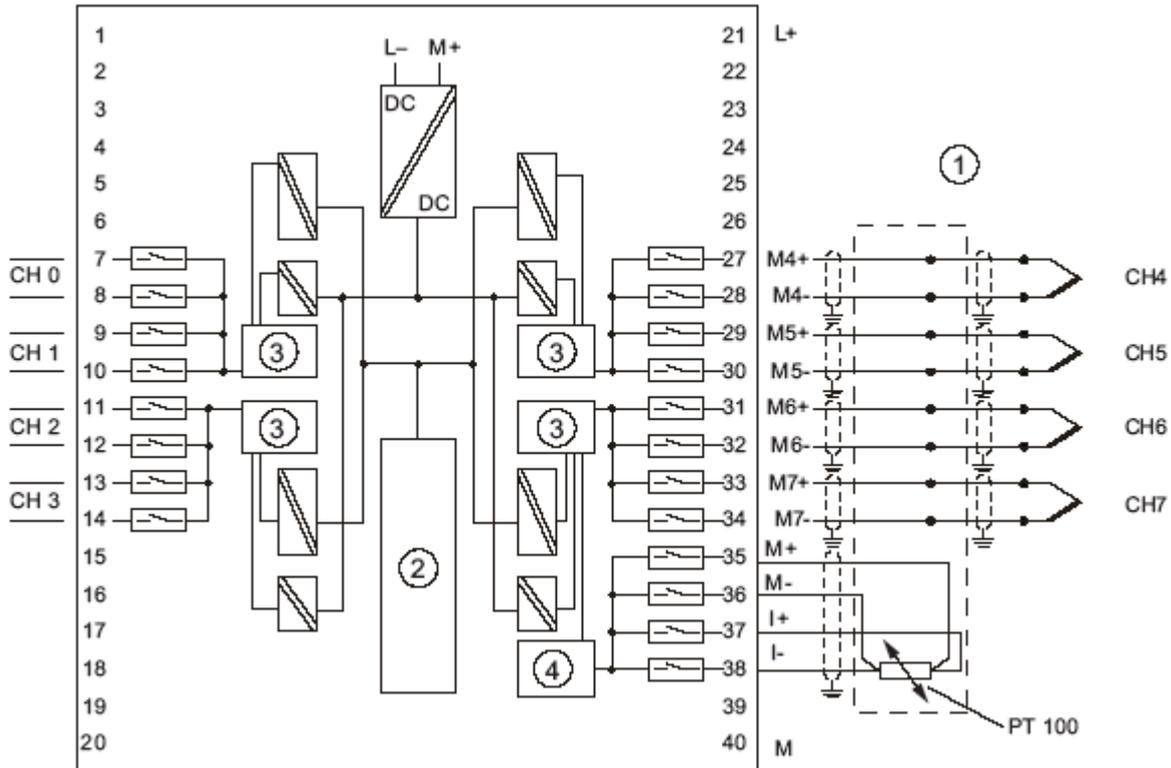
Рис. 6-27. Схема подключения и принципиальная схема
