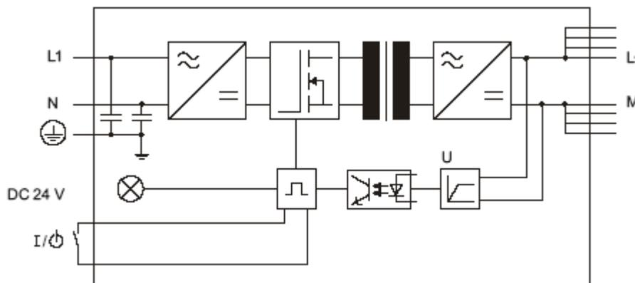
Рис. 2-4. Принципиальная схема блока питания PS 307; 10A
