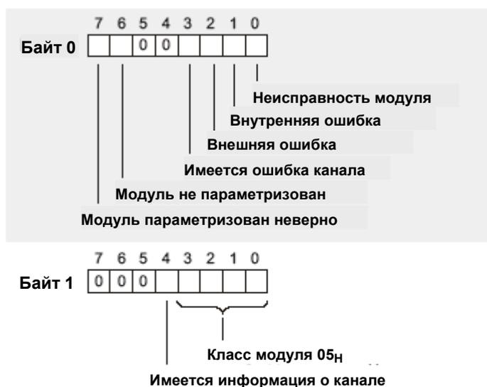
Рис. В-8. Байты 0 и 1 диагностических данных для SM 338; POS-INPUT
