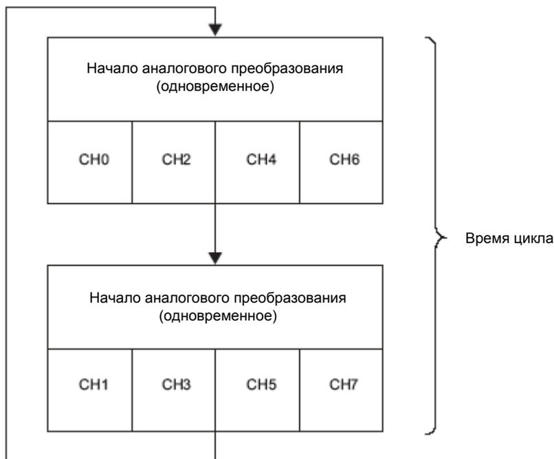
Рис. 6-29. Время цикла для 8-канального режима (аппаратный фильтр)
