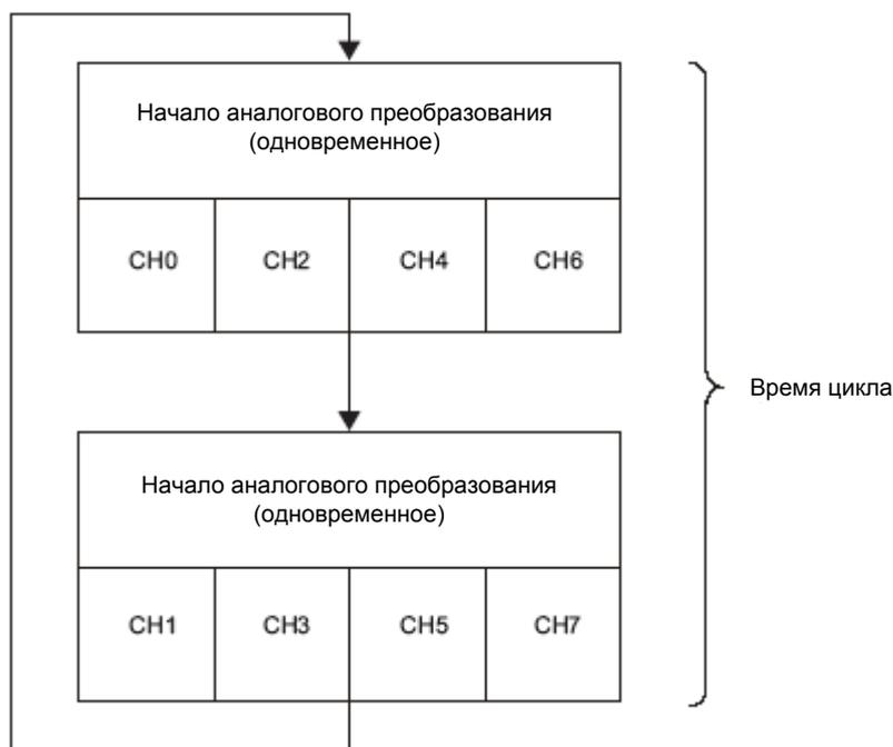
Рис. 6-23. Время цикла для 8-канального режима (аппаратный фильтр)
