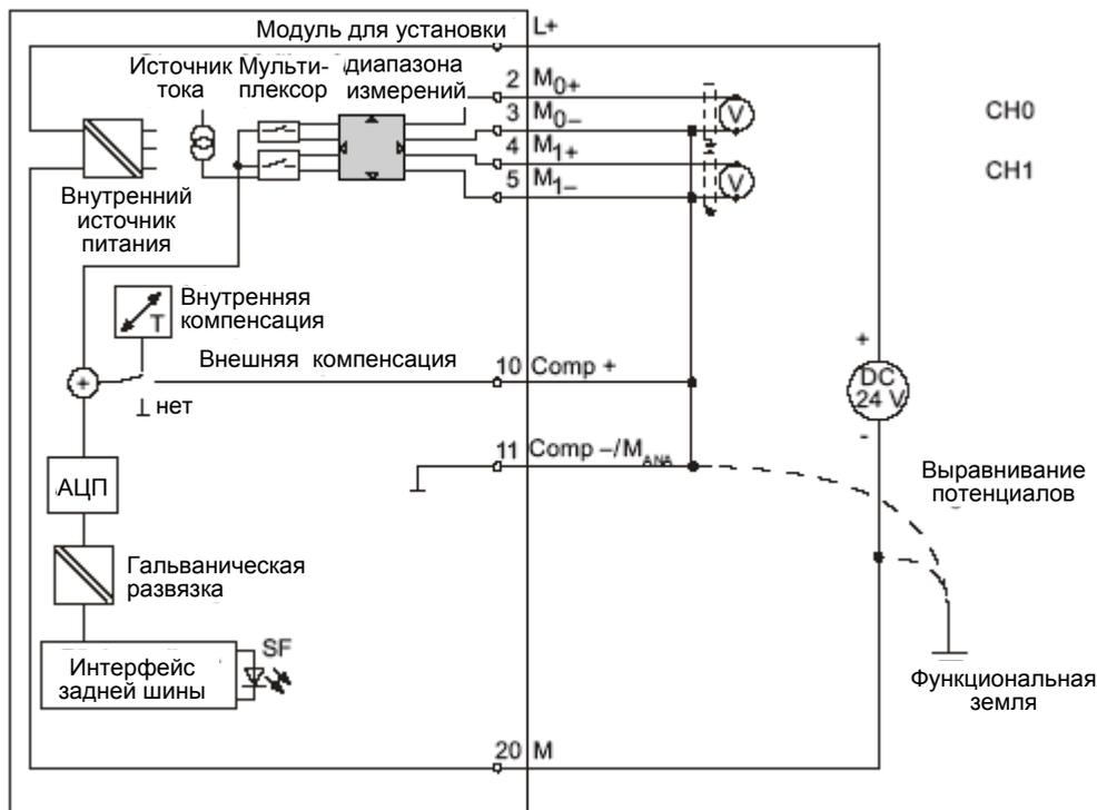
Рис. 6-18. Схема подключения и принципиальная схема
