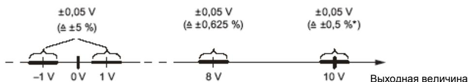
Рис. 5-3. Пример относительной ошибки аналогового модуля вывода
