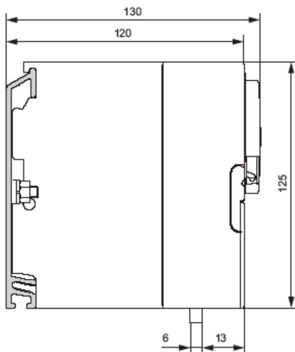
Рис. С-14. Габаритный чертеж блока питания PS 307; 5 А с CPU 313/314/315/315-2 DP, вид сбоку
