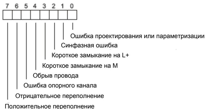
Рис. В-6. Диагностический байт для канала аналогового ввода модуля SM 331, обладающего диагностическими свойствами
