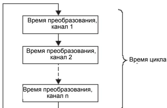
Рис. 5-4. Время цикла аналогового модуля ввода или вывода
