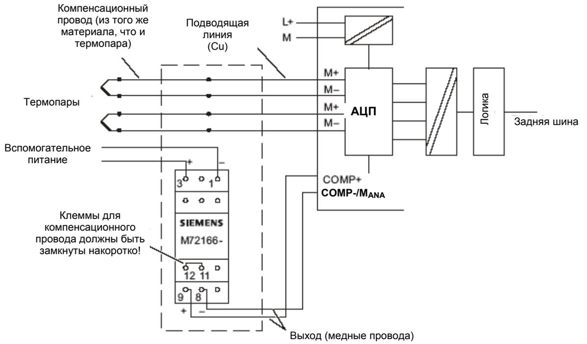
Рис. 4-16. Подключение термопар с холодным спаем (№ для заказа M72166-xxx00)
