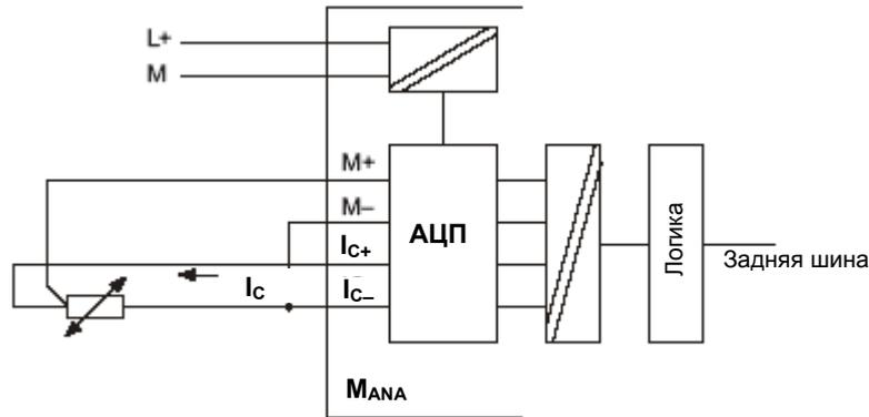
Рис. 4-10. 3-проводное подключение термометра сопротивления к аналоговому модулю ввода с гальванической развязкой
