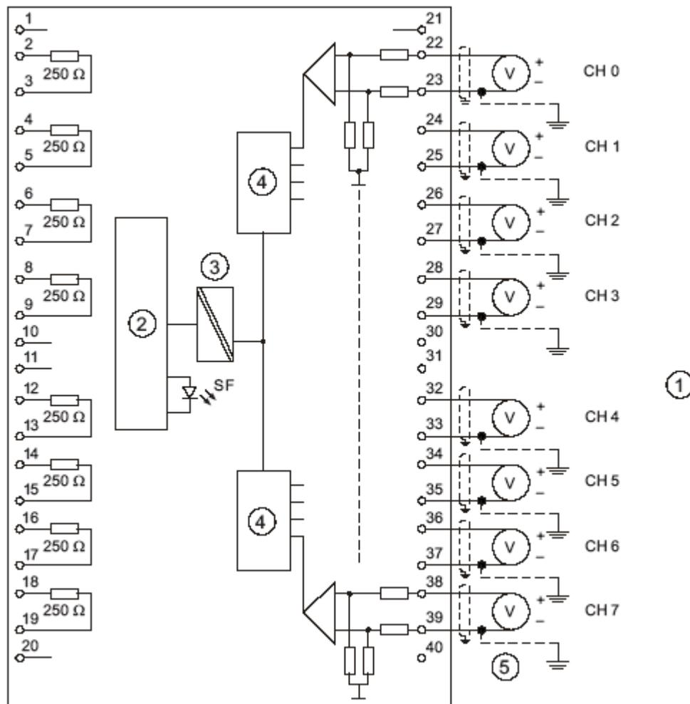
Рис. 6-1. Схема подключения и принципиальная схема
