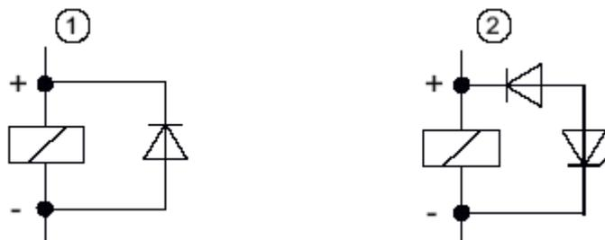
Рис. 3-2. Схемы защиты для катушек, обтекаемых постоянным током
