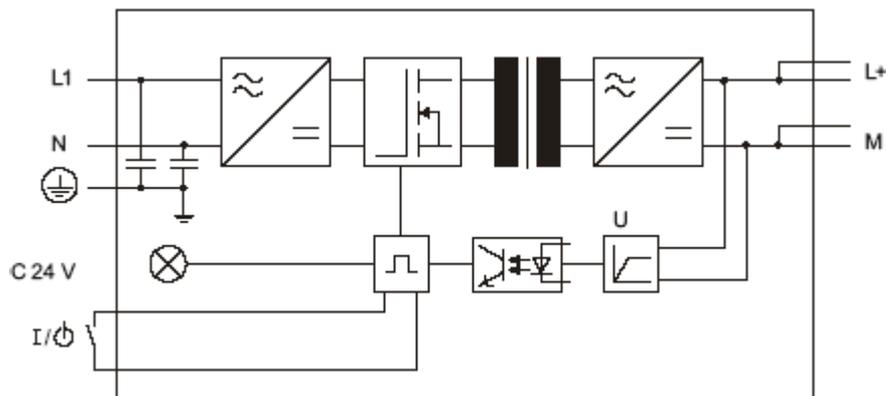
Рис. 2-2. Принципиальная схема блока питания PS 307; 2 А
