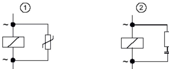
Рис. 3-3. Схемы защиты для катушек, обтекаемых переменным током
