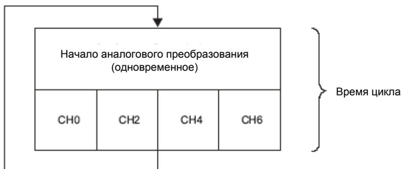
Рис. 6-25. Время цикла для 4-канального режима (аппаратный фильтр)
