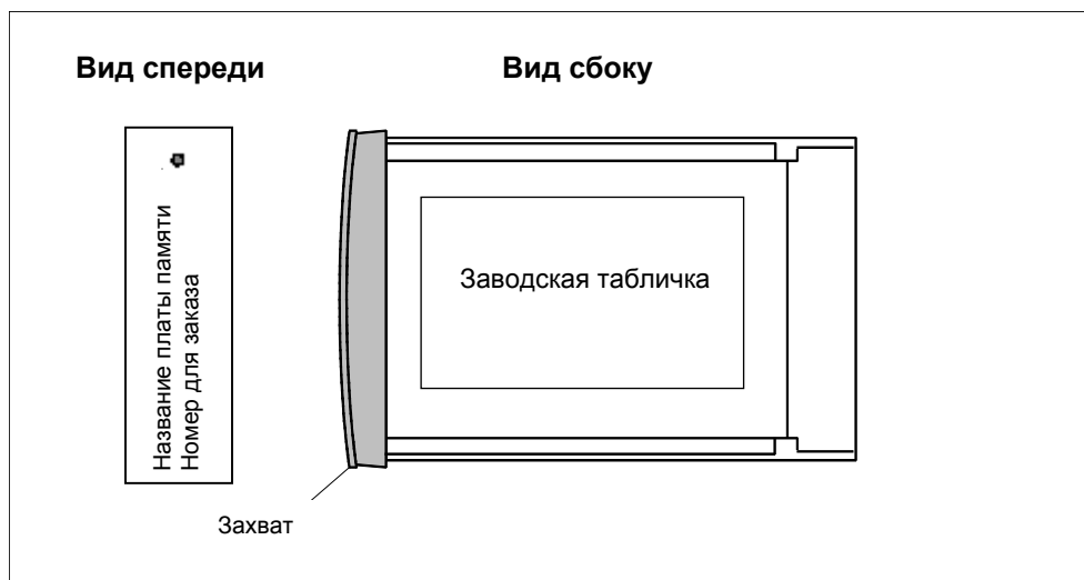
Рис. 1–6. Устройство платы памяти
